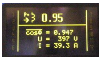
1. Ekran pomiarowy: obciążenie ind. przepływ zgodny, wsp. mocy chwilowy, wsp. mocy , średni utrzymany , napięcie, prąd.
