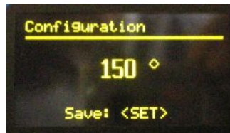
8. Ustawienie użytkownika /przekładnik prądowy w fazie L2 z odwróconym prądem, napięcia pomiar faza L2; L3.
