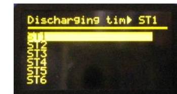
12. Ustawienie czasu rozładowania kondensatora 1st.
