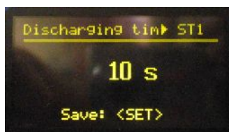
13. Ustawienie czasu rozładowania kondensatora 1st. na 10s
