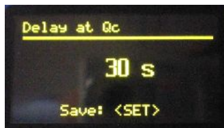
10. Ustawienie nadkompensacji na 30s Parametr może spadać - Od 1kr/s do 30kr/s – wyzerowanie parametru powoduje odłączenie stopnia wyj. reg.
