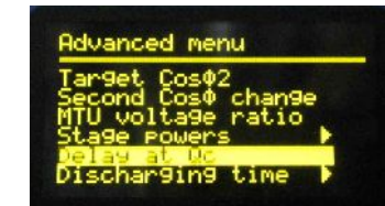
9. Ustawienie szybkości regulacji przy nadkompensacji / Parametr maleje przy nadkompensacji/.
